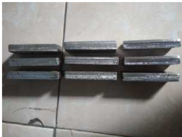
Gambar 6. Hasil Penyayatan Benda Kerja Menggunakan Mesin Frais Vertikal ( End Milling )
