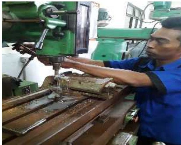
Gambar 5. Proses Penyayatan Benda Kerja Menggunakan Mesin Frais Vertikal ( End Milling )
