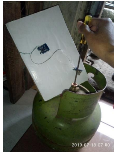
Gambar 3.5 Pengujian Sensor MQ-2
