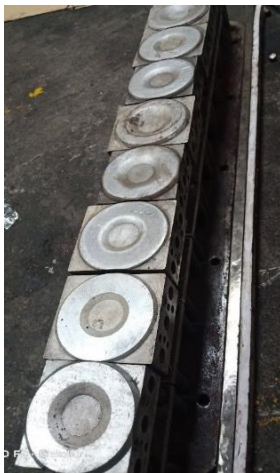
Sealdisk Heater yang Digunakan untuk Merapatkan Lid ke Cup Sebelum Direpair
