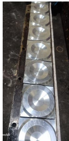
Sealdisk Sesudah Direpair
