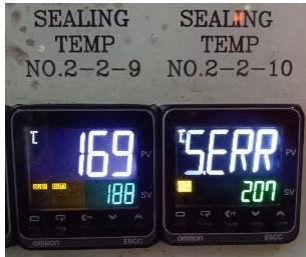
Suhu Sealing Temp yang Mengalami Eror
