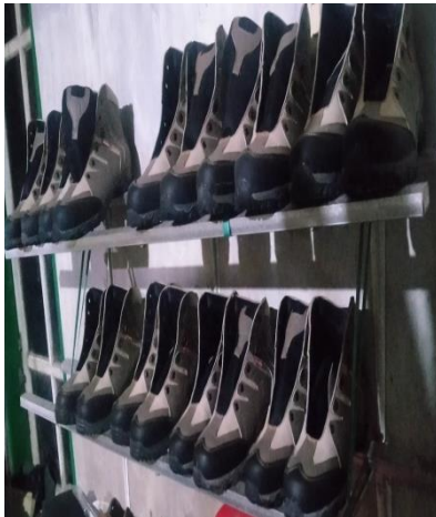
Gambar 19 Sol Sudah Terpasang
