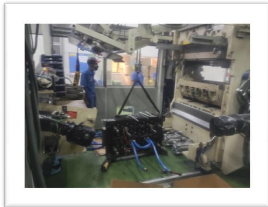
Gambar Perbaikan Selang Pecah Pada Tools Cetakan
