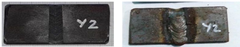
Gambar 1. Bentuk kampuh V sebelum dan sesudah disambung
