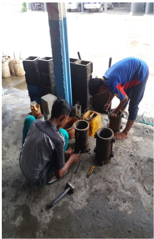
Pelepasan Cetakan Benda Uji
