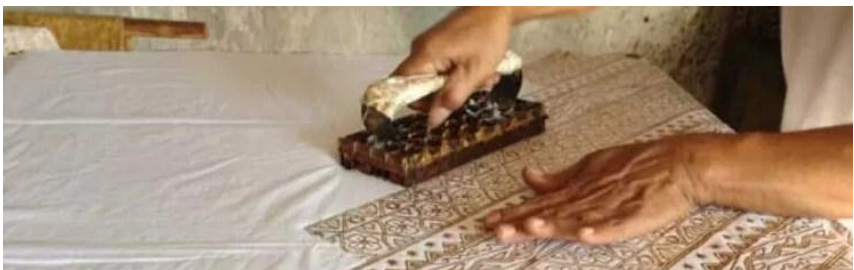
Gambar 6. Pembuatan batik dengan metode tulis menggunakan cap.
