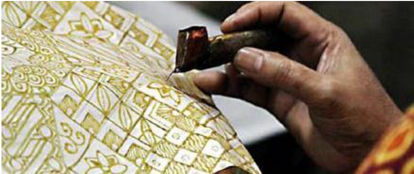
Gambar 5. Pembuatan batik dengan metode tulis menggunakan canting.
