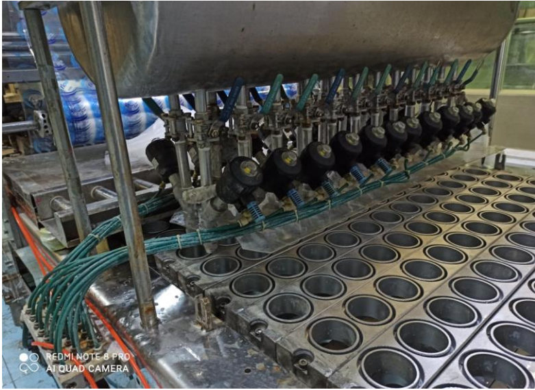
Foto Proses Pengisian (Filling Unit)
